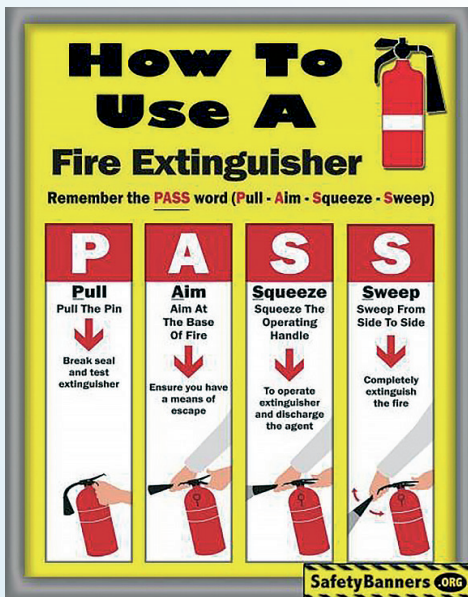
Рис. 10. Як користуватися вогнегасником. Джерело: SafetyBanners.org
