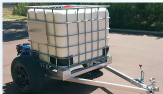
Рис. 13. Протипожежний трейлер, оснащений резервуаром на 1000 л
